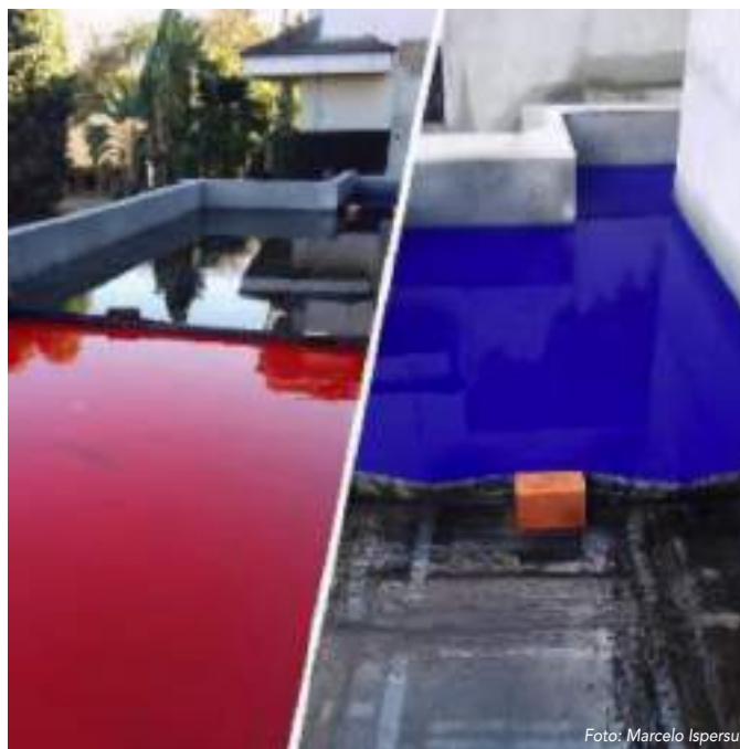
Exemplo de teste de estanqueidade em manta asfáltica feito com água e corante
