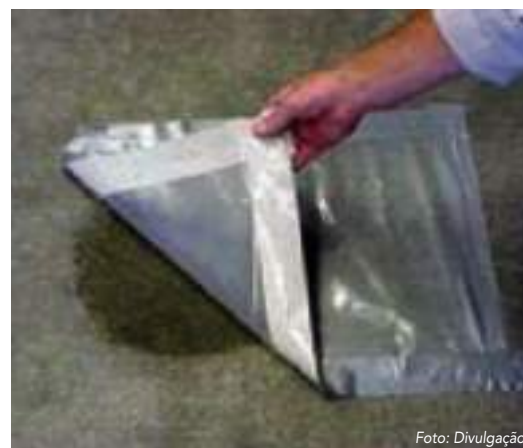
Foto: Divulgação Exemplo de teste de umidade positivo, apresentando condensação
