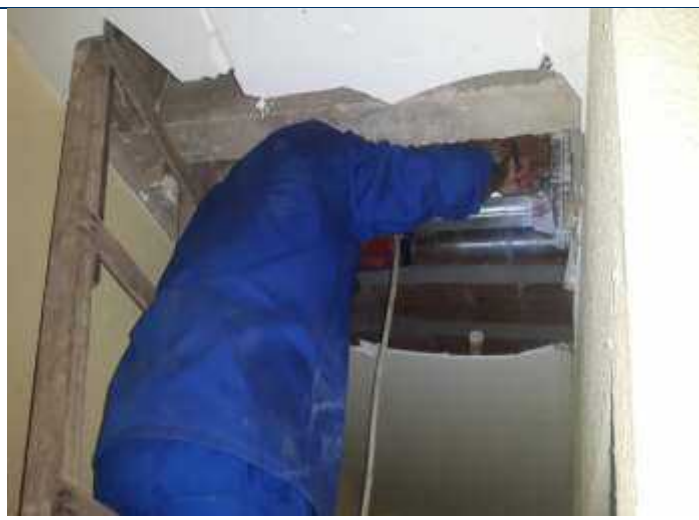
Foto 62 – Extração de testemunhos de concreto.
