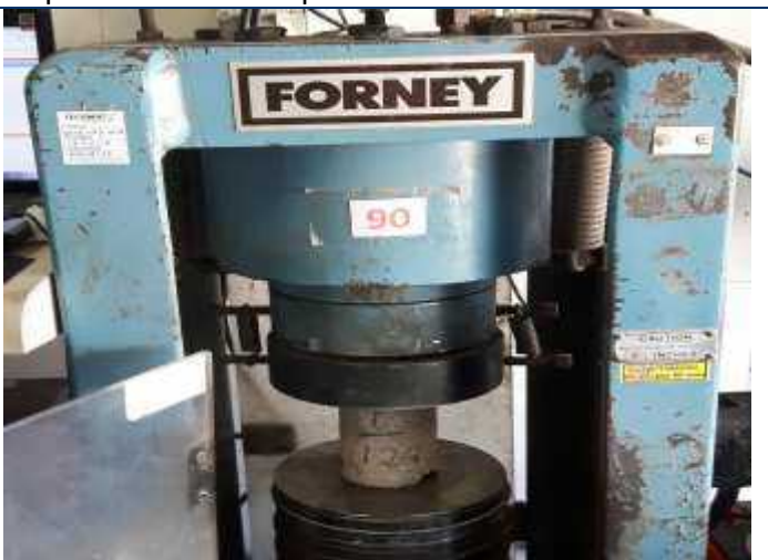
Foto 136 – Rompimento dos testemunhos de concreto.
