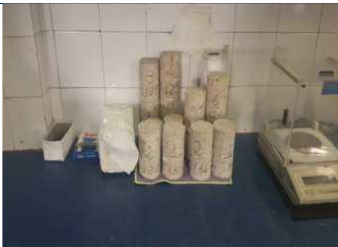
Foto 135 – Testemunhos de concreto no laboratório
