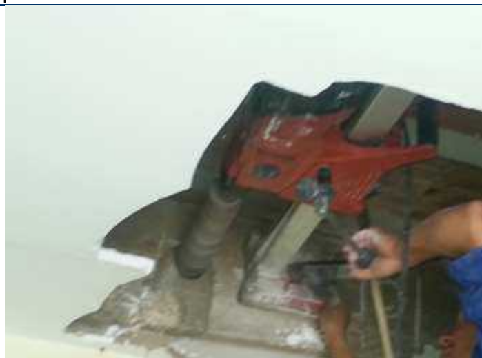
Foto 66 – Extração de corpos de prova na viga.
