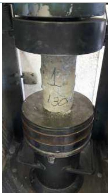
Foto 56 - Ruptura dos corpos de prova da Viga 1.
