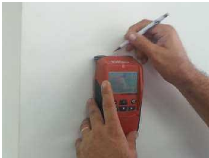
Foto 07 – Verificação da ferragem com o ferroskan.
