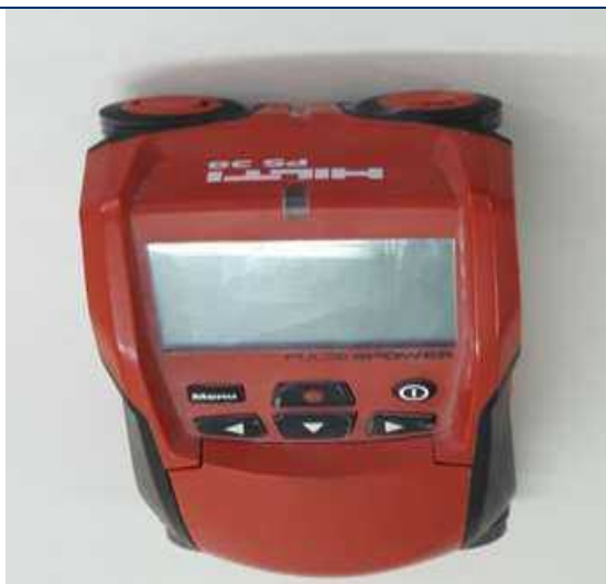
Foto 17 – Multidetector (Ferrosan), marca HILTI, modelo PS 38.
