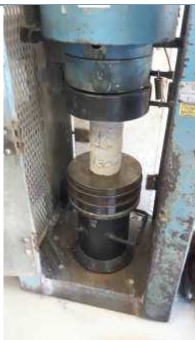
Foto 55 - Ruptura dos corpos de prova da Viga 1.
